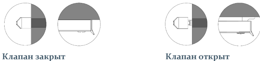
Рис.2 Вид клапана в положениях «открыто» и «закрыто»
